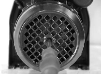
С целью предотвращения блокировки механического запора, перед запуском или после продолжительного неиспользования насоса провернуть вал через вентилятор.
